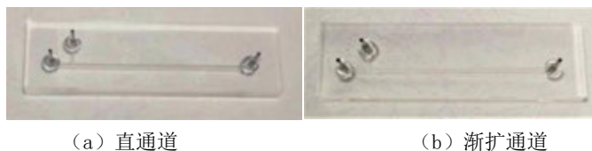
图 2 实验用加工微通道实物图
