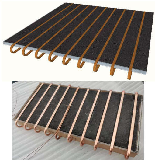
图 4 相变材料耦合热管控温模块 (PCM/HP) 示意图和实物图
