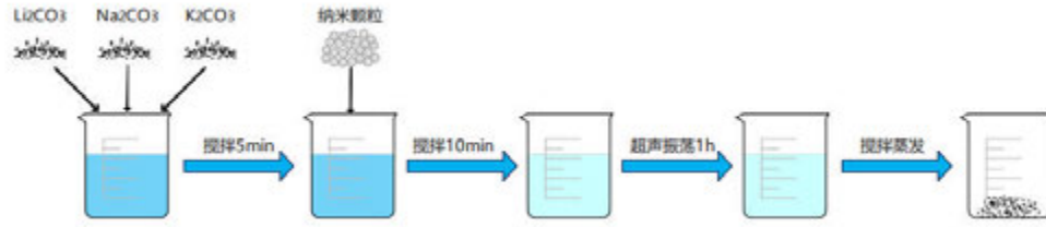
图 2 水溶法制备三元碳酸盐复合材料流程图
