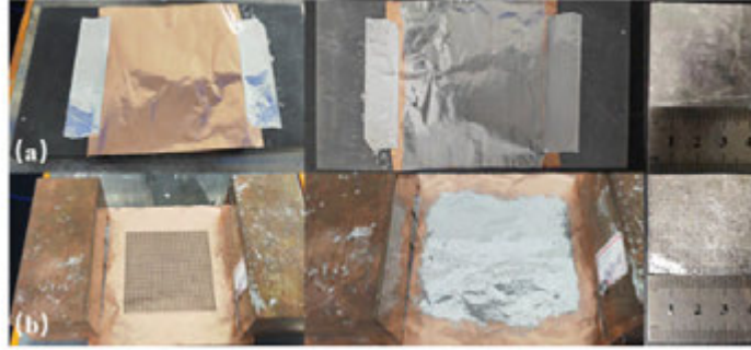
图 2 不同单层金属基材的实验样品：(a)铜箔基底；(b)打孔铜箔基底
