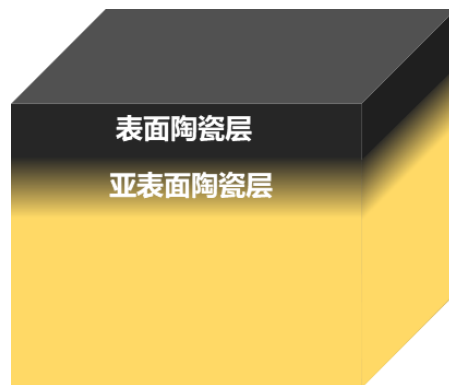
图2 抗氧化陶瓷层结构示意图
