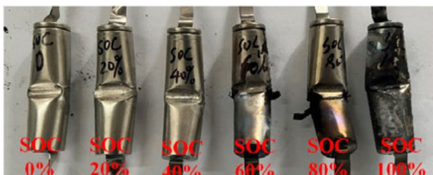
图 7 挤压实验后的锂离子电池
